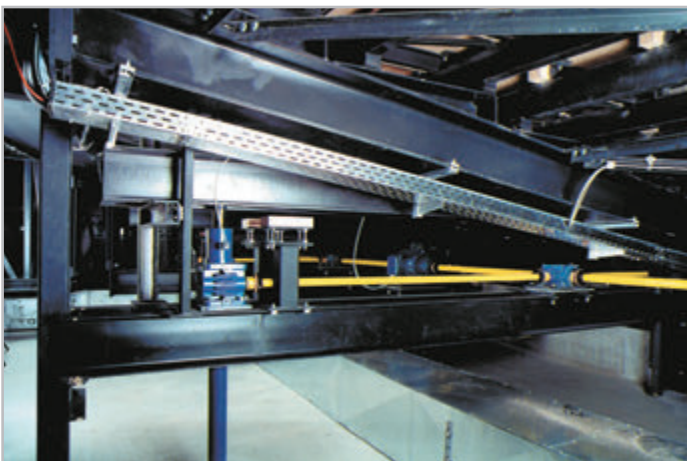
应用图例： SBS Bühnentechnik 有限公司 多丝杠升降系统(HSE 高性能蜗轮丝杠升降机)， 根据BGV C1 (VBG 70)装有安全装置，用于调节 法兰克福文化中心的大厅看台。通过锥齿轮箱和 连接轴实现同步。
