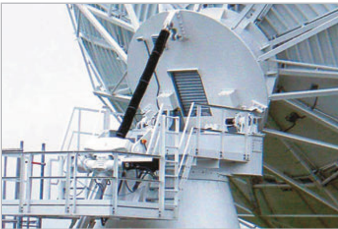
HSE 高性能蜗轮丝杠升降机，为11.1m天线实现俯仰运 动而设计的特殊结构，工作温度0 ° C 到90° C 。
